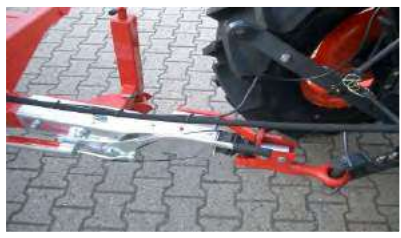
verstellbares Stützrad und Auflaufbremse
