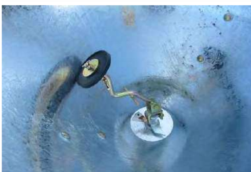
Rührwerk für Salz
