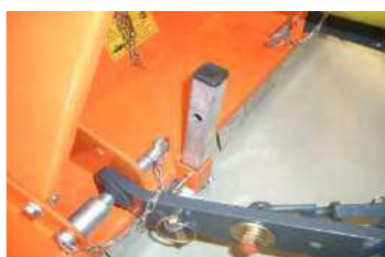
Abstellstützte zum problem- losen Abbau des Gerätes
